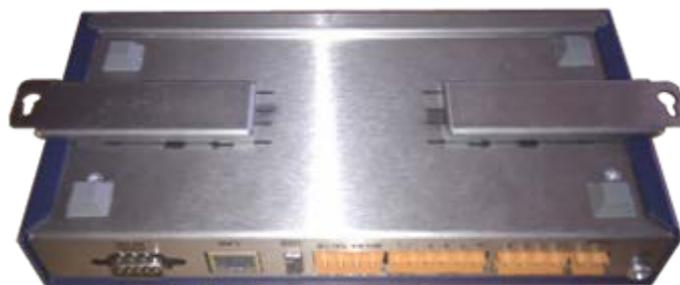
2. Lever les 2 languettes pour bloquer les fixations :
